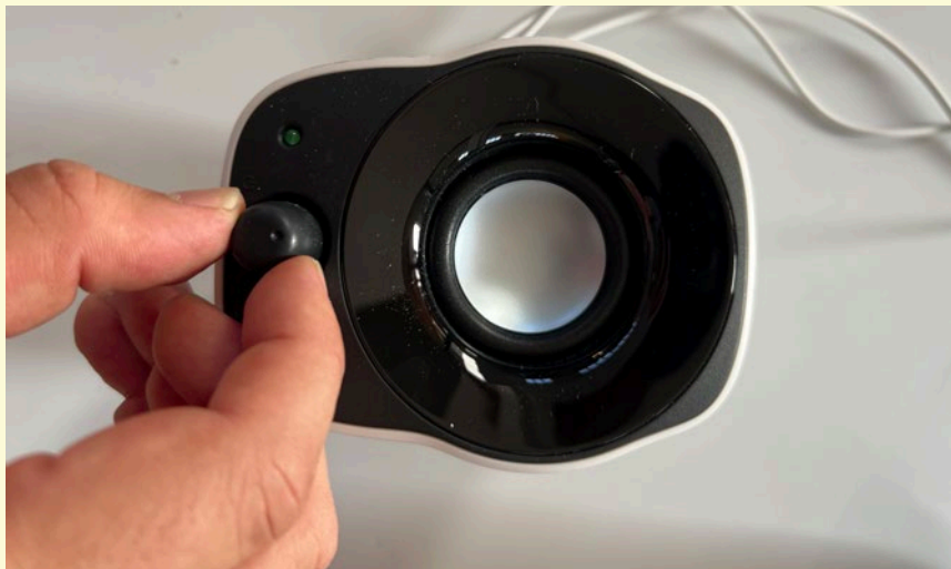
Ajustem el volum dels altaveus mitjançant el seu potenciòmetre frontal
